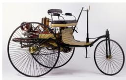
Benz era um engenheiro mecânico, nasceu na Alemanha e patenteou um carro de três rodas, com o seu próprio sistema de acelerador, velas de ignição, engrenagens, radiador de água, carburador e outras ferramentas necessárias no sistema interno do carro. A partir daquela época, Benz construiu uma companhia de carro que existe até hoje, o Grupo Daimler.
